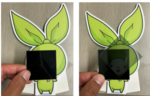
図 4. 透過軸が互いに直交する 2 枚の偏光板を置いた場合 (左) と, その 2 枚の偏光板の間にもう 1 枚の偏光板を  $45^\circ$  傾けて挿入した場合 (右) の写真.
