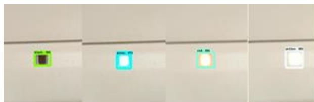
図 7 アクセスポイントの LED 判別例 (左から無点灯、緑、赤、黄)
