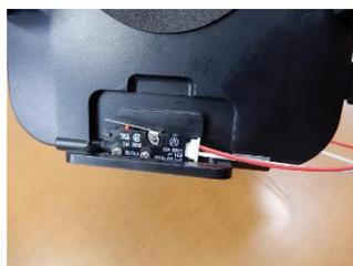
図 14 マイクロスイッチによるタブレットの返却検知
