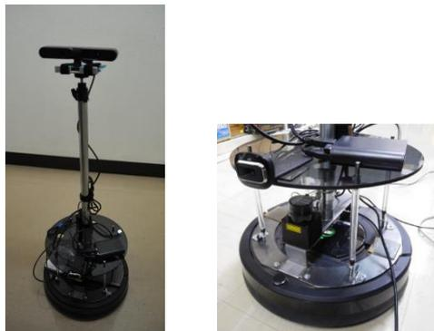
図5 情報収集を行う移動ロボット（左：ロボット全体像、右：センサー群）
