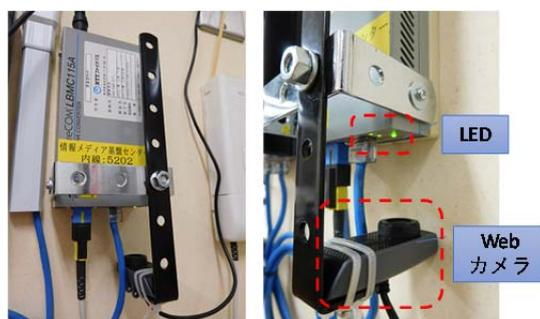
図 2. 監視装置のアタッチメントの装着例
