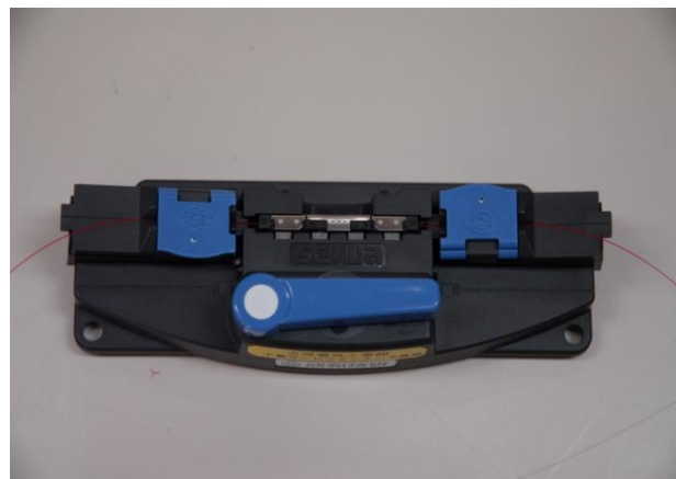
写真 13 メカニカルスプライスの施工
