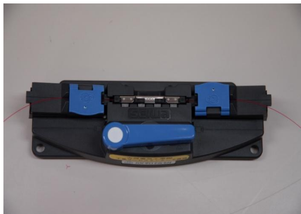
写真 13 メカニカルスプライスの施工
