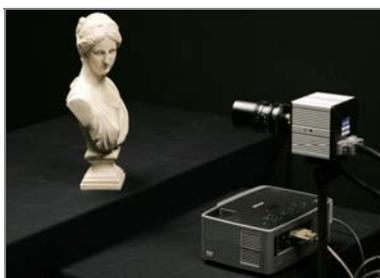
図.1 DLP の高周波歪を使った、構造化光による高速度形状計測システム
